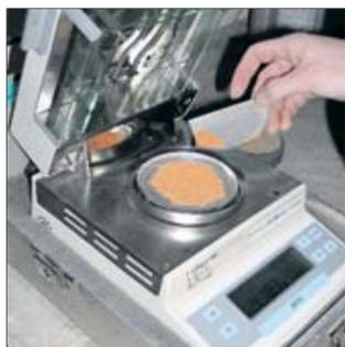
Feuchtigkeitsmessung mit der elektronischen Präzisionswaage. Schmidt (2)
